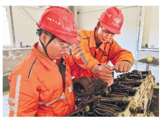
近日,中铁十九局集团矿业公司新入职的235名新职工陆续抵达施工一线。公司把技术革新与传帮带工作作为新职工融入企业的重头戏,由经验丰富的老师傅、岗位能手与新职工签订师徒帮带合同。图为有着30年设备维修经验的大苏计钼矿项目修理厂厂长李放在指导徒弟攻克矿用自卸车发动机维修难题。 本报记者 刘静 通讯员 冯宏超 霍常亮 摄
